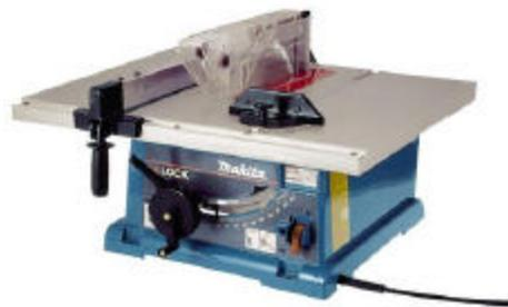
**Serruchos de Mesa:** Ajuste la hoja del serrucho de mesa para que se proyecte aproximadamente 0.3 cm sobre la madera. Asegúrese que la pieza de madera no esté en contacto con la hoja al hacer partir o parar el serrucho. Mantenga su cuerpo fuera de alcance. Use un trozo de madera para empujar al aserrar franjas angostas. Baje la hoja del serrucho bajo la mesa cuando termine su trabajo.
