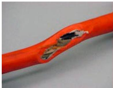
**Daño al Cordón** Un cordón flexible puede ser dañado por una puerta o los bordes de una ventana, por corchetes y sujetadores, por abrasión de materiales adyacentes, o simplemente por el paso del tiempo. Si los cables conductores quedan expuestos existe riesgo de choques, quemaduras o incendios.
